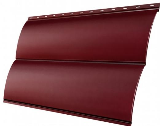
При монтаже металлосайдинга помните, что материал, в зависимости от погодных условий будет сжиматься и расширяться, поэтому оставляйте промежуток 6-7 мм. Не прикручивайте лист до упора, оставляйте промежуток. Обязательно начинайте установку от центра к углам. Панели фиксируйте по центру технологических отверстий.
